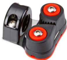
CB-0602F Podstawa ruchoma Max Lina: 3-6mm SWL : 80 kgs MAX: 160 kgs Waga: 95 g
