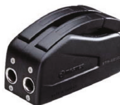
XTC-04082F Podwójny Max Lina: 4-8mm SWL : 180 kgs MAX: 550 kgs Waga: 815 g
