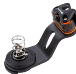
CB-1202FE Podstawa ruchoma Max Lina: 3-12mm SWL : 100 kgs MAX: 200 kgs Waga: 353 g
